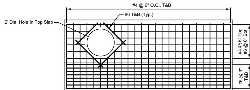
TOP SLAB REINFORCEMENT PLAN
